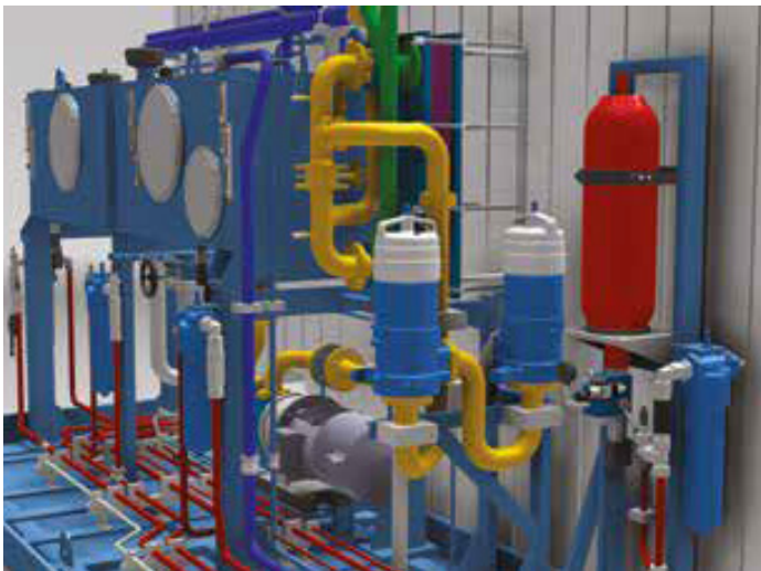
Hidraulikus próbapad csővezetékrendszerének 3D modellje és az elkészült csőhálózat
